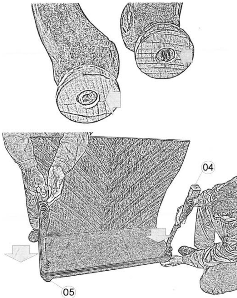
Установить ножку 04 гайкой в нижнем торце на шпильку опоры 05. Придерживая ножку 04 завернуть опору точеную по часовой стрелке до упора.
