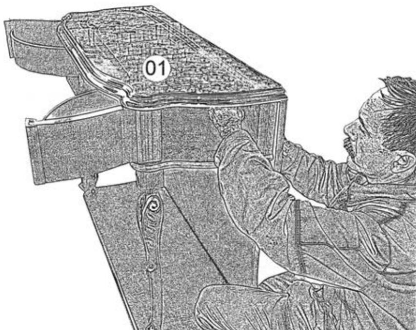
Крепить стенку вертикальную крышки в сборе 01 к задней стенке 03 при помощи отвертки на межсекционную стяжку.
