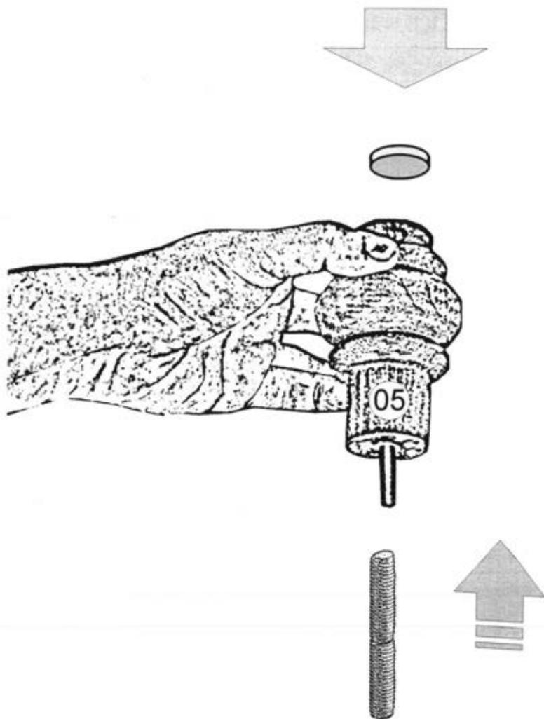
В торец опоры 05 установить шпильки, завернув их до упора по часовой стрелке. Наклеить фетровые самоклеящиеся подкладки.
